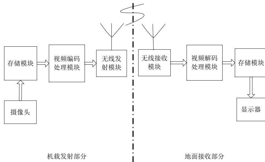
系统整体主要包括两大部分，机载的图像压缩无线发射部分，负责将采集到图像信息进行压缩处理，并无线发射到地面；以及地面的无线接收解码部分，负责将从无人机发射的压缩图像信息接收到指挥中心，并对其进行解码处理，完成直观性的显示。
