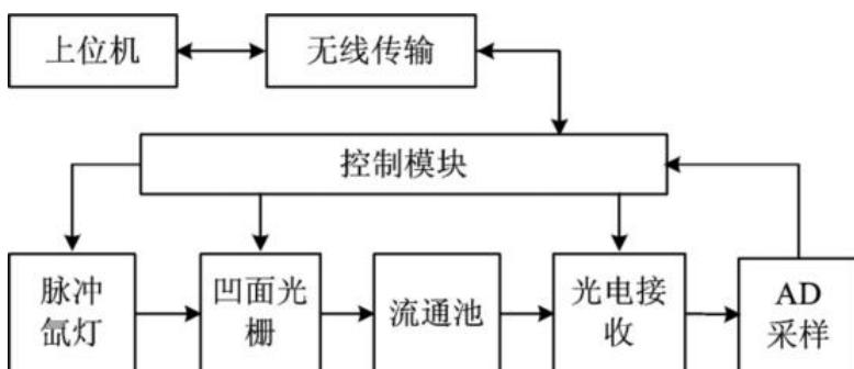
水质监测仪器框图如上图所示，由光路系统，开放流通池，光电接收 / 转换系统，控制系统等四个模块组成。脉冲氙灯发出的光，经由步进电机带动的凹面光栅分光系统组成的单色器装置，分离出来的单色光进入开放流通池，被吸收后的光信号经光电二极管转化成相应的电信号，经过 A/D 转换后再通过无线数据传输传送到上位机进行实时显示、存储并处理。该仪器由上位机监控软件控制操作。可测量光谱范围为 200~720nm。
