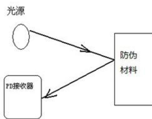
图 1 防伪检测原理图
