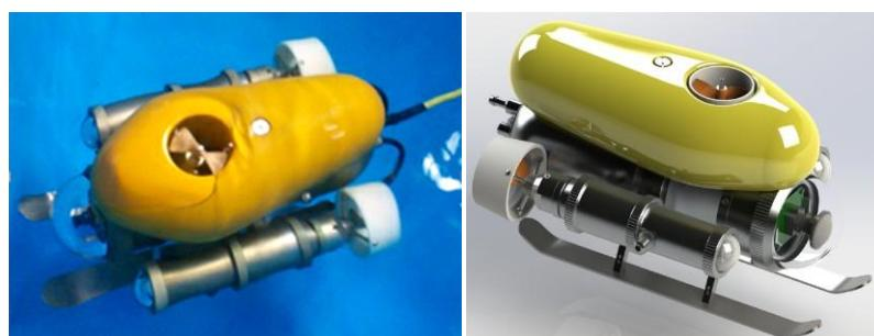
**技术特点：**该微型缆控水下观测机器人采用磁耦合传动技术、直流载波技术、超细中性浮力凯夫拉缆技术、自动航向保持和定深技术、高效水动力外形设计技术，平台具有极大的技术先进性。其操作简便简单，便携小巧。
