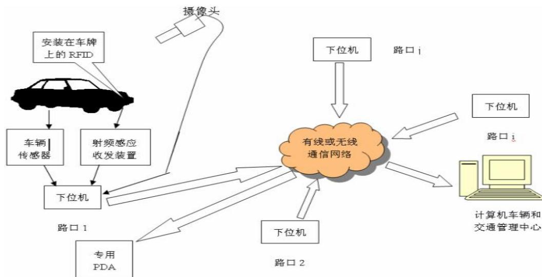
**技术水平及专利与获奖情况：**该机采用了当今最先进的 RFID(射频识别卡)、微处理器技术和网络技术。已申请国家发明专利：基于射频识别的车辆交通监控
