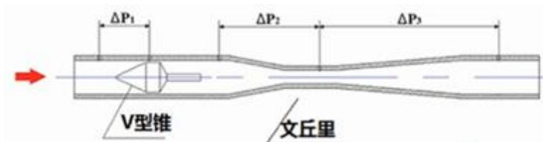
图 3 “双节流三差压”传感器结构
