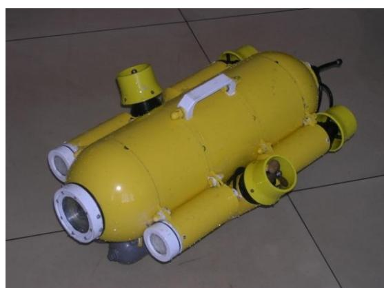
技术特点：该微型缆控水下观测机器人采用磁耦合传动技术、直流载波技术、超细中性浮力凯夫拉缆技术、自动航向保持和定深技术、高效水动力外形设计技术，平台具有极大的技术先进性。其操作简便简单，便携小巧。
