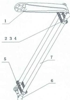
1) 主动臂 2) 球关节连接件 3) 从动臂连接销 4) 销端螺母 5) 从动臂拉簧
