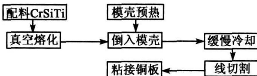
所制备的靶材( $382\text{ mm} \times 128\text{ mm} \times 14\text{ mm}$ )在溅射成电阻器薄膜后，电阻温度系数小( $\leq 25 \times 10^{-6} / ^\circ\text{C}$ )，电阻值高(要求不刻槽数量级为千欧，刻槽后数量级为兆欧)且稳定(随时间变化小)，因此，在本靶材研究中，将选择 Cr 、 Si 作为高阻靶材的主体材料。由于 Cr 、 Si 熔点高，原子移动性低，因此由其所组成的薄膜稳定性高。通过在金属 Cr 中引入半导体材料 Si 来提高电阻器合金膜的阻值。Cr 是很好的吸收气体的金属元素，在电阻器薄膜溅射过程中，可通过通入微量的氧来提高薄膜的电阻率，同时调节电阻温度系数。
