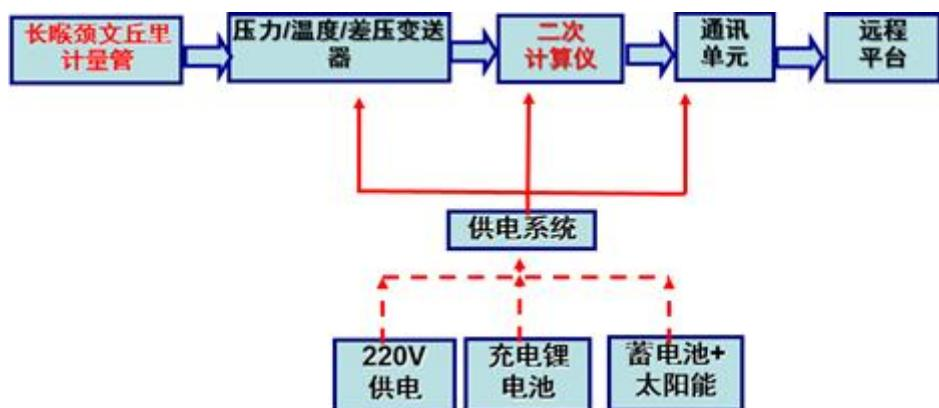
图 1 凝析天然气两相流量计系统构成
