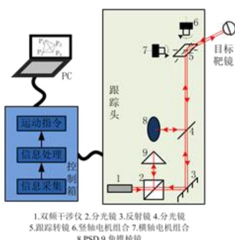
跟踪系统结构图如上图所示，检测原理为：
