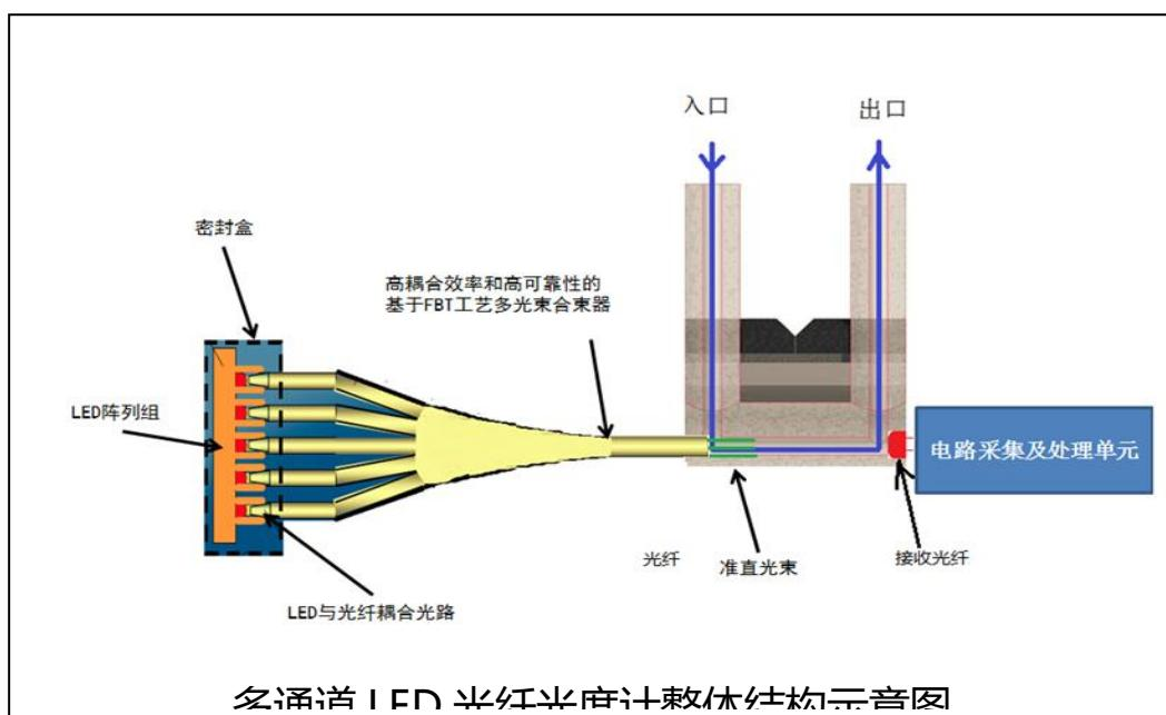
通过对光路系统，自动化控制系统及湿化学分析方法的创新，应用间断化学分析进样技术，“U”型长光程流通池，及多波长 LED 光束耦合技术，开发出一种高精度、低检测限、低功耗、低剂量，可应用于海水、地表水、地下水的全自动水质营养盐在线分析仪，并实现成果转化及批量化生产。
